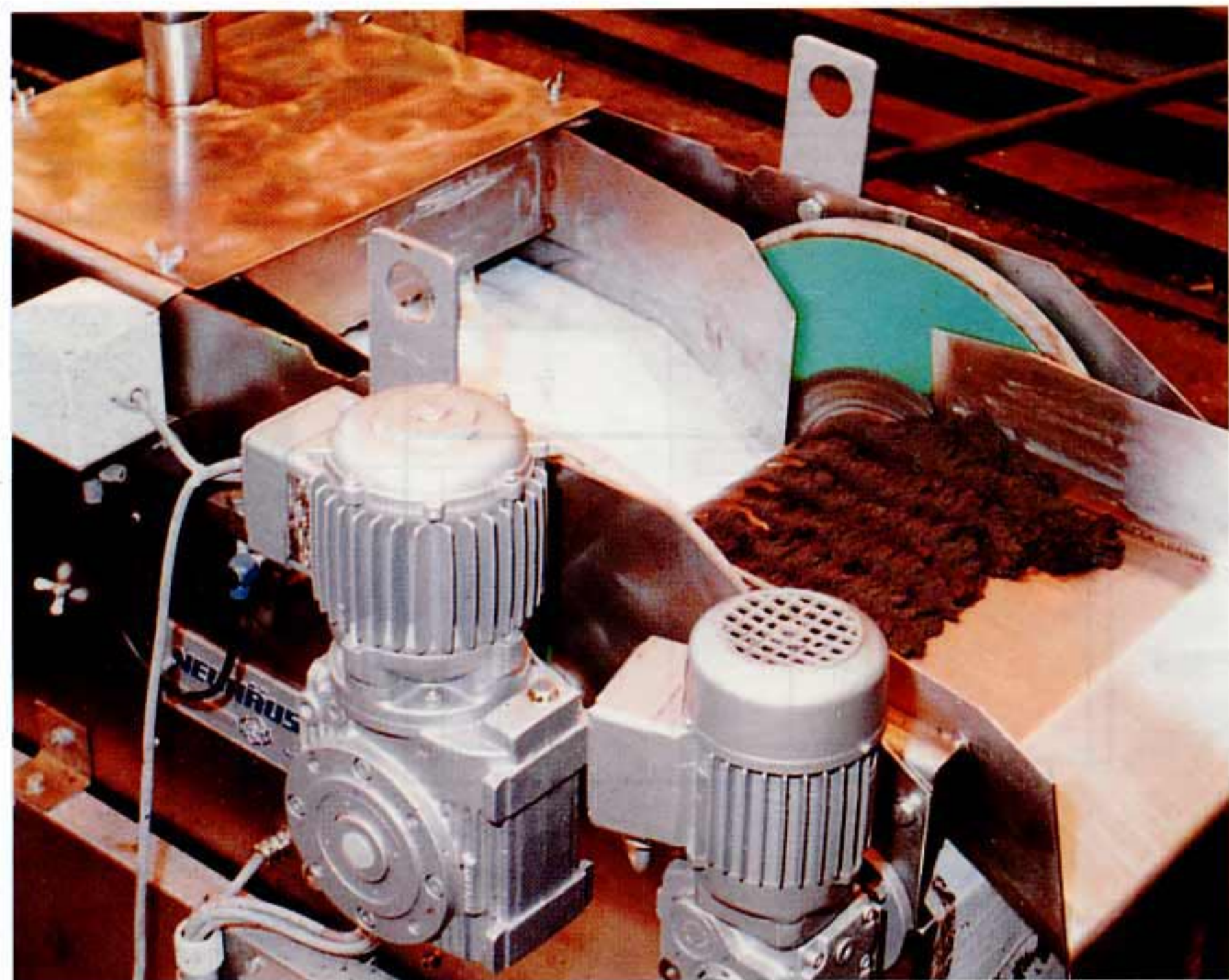
Kompaktbandfilter Typ 4.7-1 mit einer Leistung von 180 l/min Emulsion
