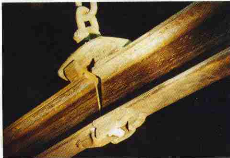
Wirkungsvoller Verbesserungsvorschlag zur Verschleißminderung der Verbindungsstücke an EHB-Schienen.
